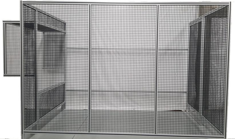
Fabricadas a medida con perfil de aluminio estructural tipo Bosch de 45x45mm malla electro-soldada con recubrimiento en PVC de 1x1", con tornillería Bosch, anclajes al suelo y puerta medida standard
